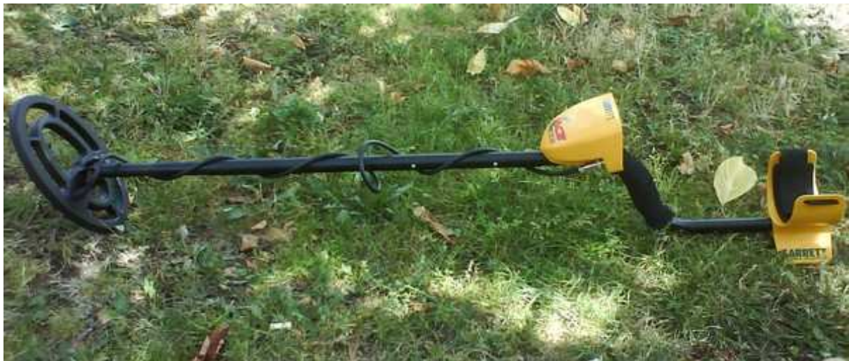
Стандартната конфигурация предлагана от фирмата производител. Garrett ACE 250 в сглобен вид
