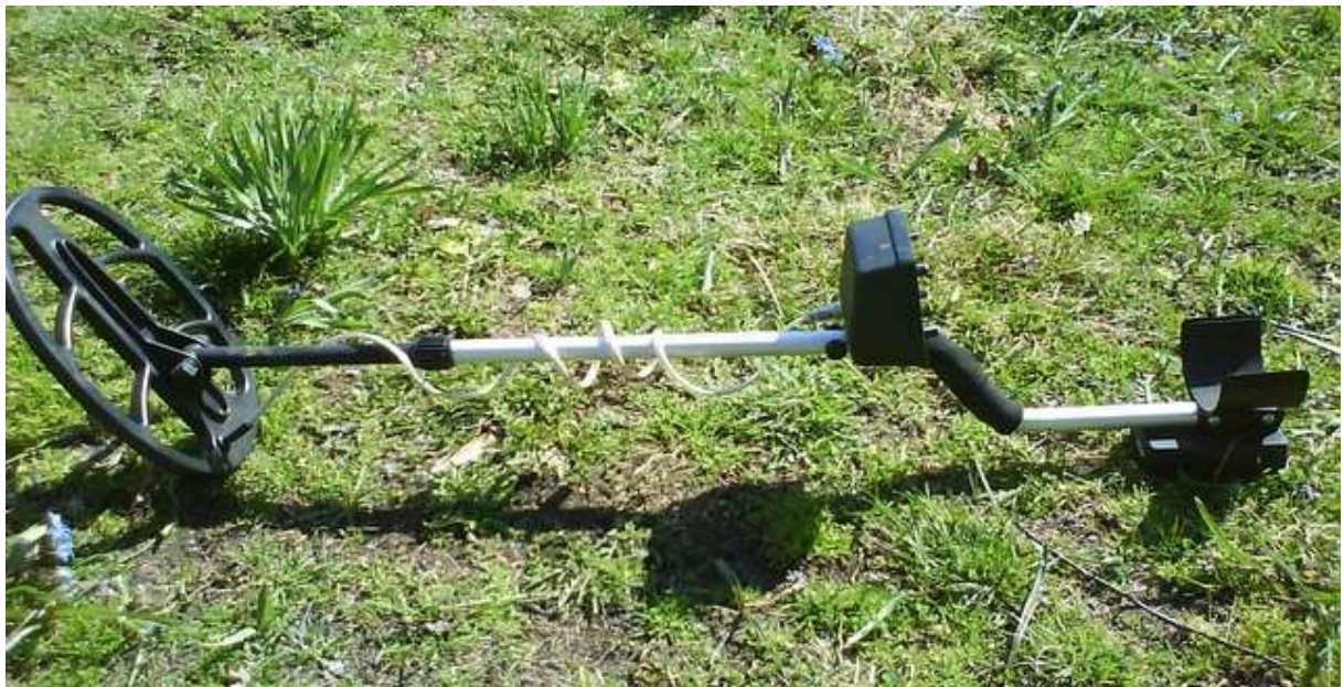
NRG 100 с максимално прибрана долна част. По този начин апарата се побира в багажника и на най-малкия хечбек.
